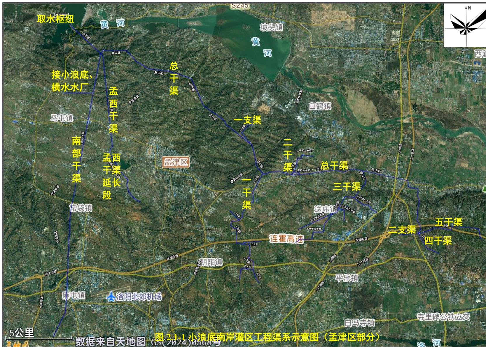
图 2.1-1 小浪底南岸灌区工程渠系示意图（孟津区部分）
